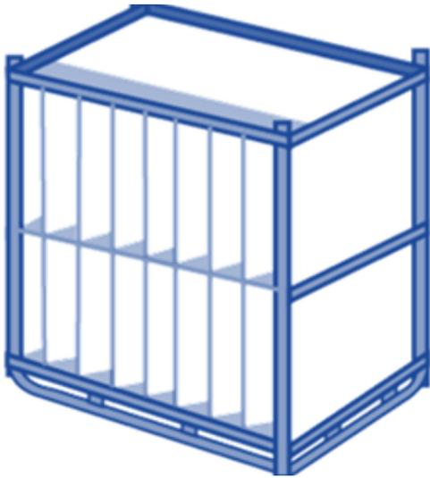
Es una estructura/armazón metálico que, de acuerdo a sus características, sirve para alojar diferentes tipos de piezas, variando en su estructura adaptando sea la anatomía del producto a albergar. Normalmente son utilizados para transportar piezas externamente frágiles.
