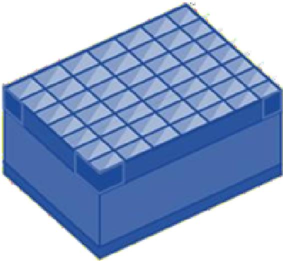
Su principal función es asegurar que una pieza que se desea transportar se mantenga en una posición determinada dentro del contenedor, evitando posible daños durante su traslado.
